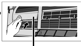
Φίλτρο καθαρισμού αέρα
